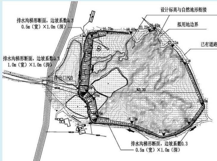
图3-6 3#弃渣场排水平面图
